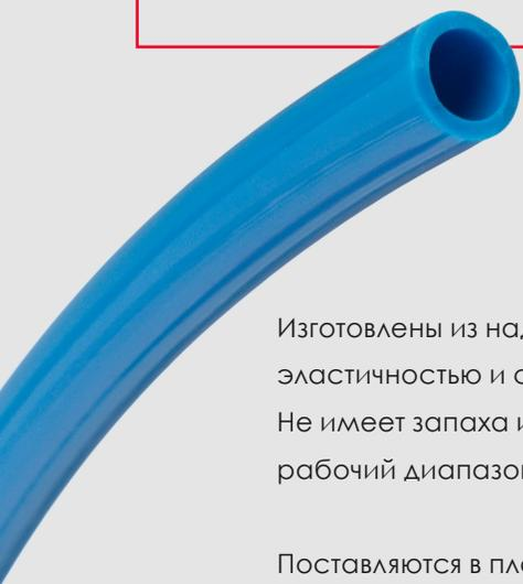
Изготовлены из надежного полиуретана (PU), который обладает отличной эластичностью и стойкостью к механическим воздействиям и температурам. Не имеет запаха и абсолютно не токсичен. Рабочее давление до 15 бар, рабочий диапазон температур от -10°C до +60°C.
