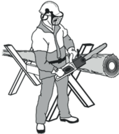
Рисунок 13. Схема розпилу колоди з використанням козлових опор.
