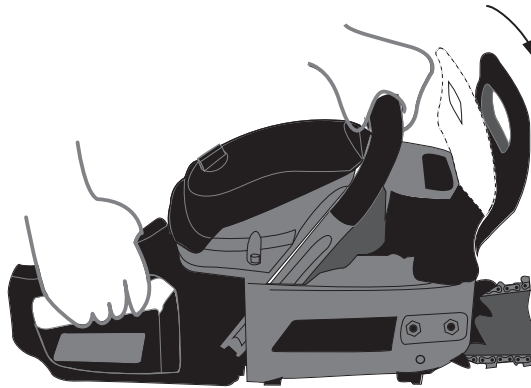
Рисунок 5. Схема роботи гальма ланцюга.
