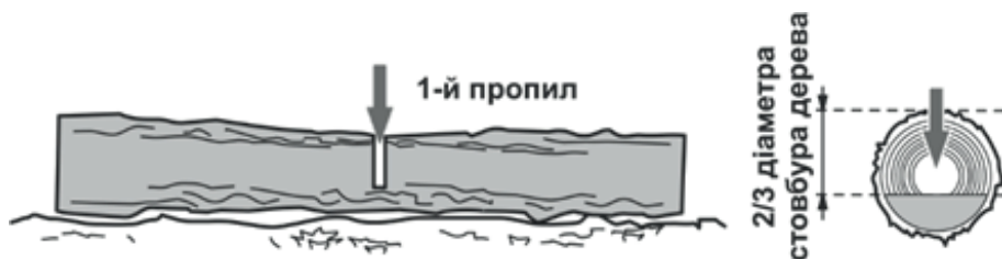
Рисунок 11. Схема попереднього розпилу колоди.
