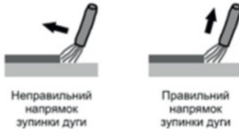
Рисунок 6. Напрямок зупинки дуги під час ручного дугового зварювання («ММА» / «ММА Pulse»).
