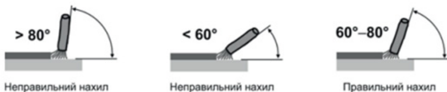
Рисунок 8. Кут розташування електрода із покриттям до деталі під час ручного дугового зварювання («MMA»).
