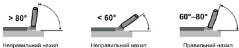
Рисунок 6. Кут розташування електрода із покриттям до деталі під час ручного дугового зварювання («ММА»).
