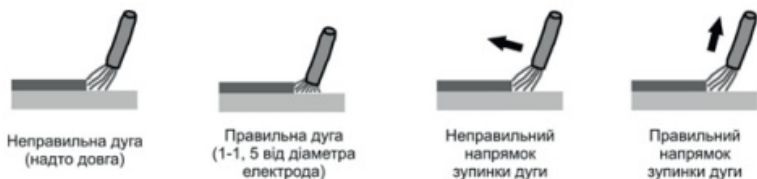
Рисунок 5. Відстань розташування електрода із покриттям до деталі під час ручного дугового зварювання («ММА»).
