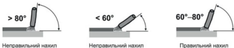
Рисунок 8. Кут розташування електрода із покриттям до деталі під час ручного дугового зварювання («ММА»).
