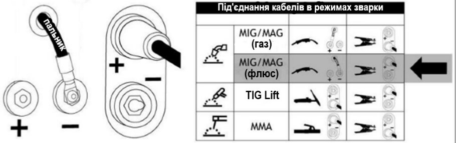
Рисунок 6. Схема під'єднання зварювальних кабелів та пальника в режимі зварювання «FCAW» («MIG/MAG FLUX»), з флюсовим зварювальним дротом.
