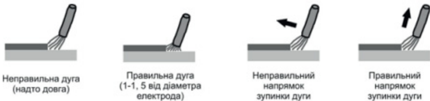
Рисунок 7. Відстань розташування електрода із покриттям до деталі під час ручного дугового зварювання («ММА»).
