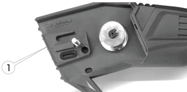
Рисунок 19. Розташування отвору подачі мастила пиляльного ланцюга.
