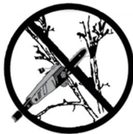
Рисунок 15. Приклад спилювання густих гілок із небезпекою «зворотного удару».
