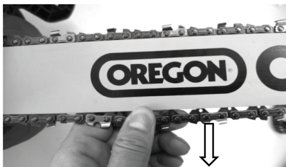
Рисунок 10. Схема перевірки правильності натягу пиляльного ланцюга.
