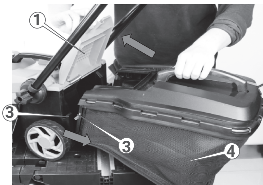
Рисунок 10. Схема під'єднання та зняття контейнера для трави (травозбірника).
