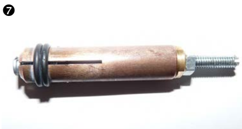
Embout en cuivre à 4 fentes pour souder les goujons M4 (diamètre Ø 4 mm)
