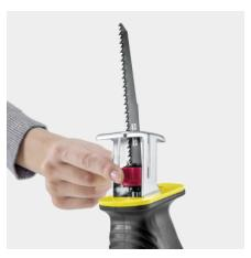
Замена пильного полотна без применения инструментов
