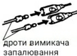
Рисунок 9. Схема під'єднання дротів вимикача запалювання.
