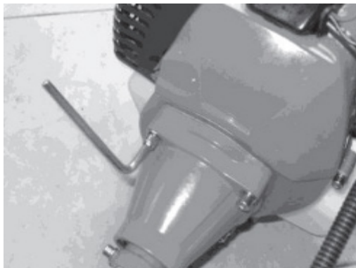
Рисунок 2. Схема приєднання «штанги» до двигуна виробу.
