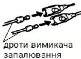
Рисунок 9. Схема під'єднання дротів вимикача запалювання.
