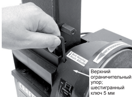
Сур. 9 Ленталық ажарлау торабын қисайту үшін бұрандаманы босату.
