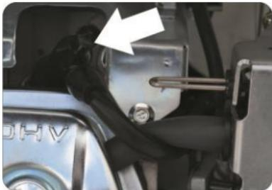
Свеча зажигания: эквивалент TORCH F6TC.
