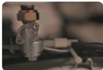
в) Установите рычаг заслонки в положение “ЗАКРЫТО”.
