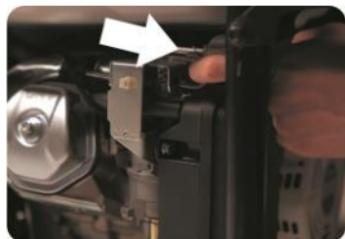
г) Нажмите кнопку электростарта на START. Если генератор укомплектован ДУ - поверните ключ вправо (Положение "Start") для запуска двигателя и нажмите на пуск ДУ.
