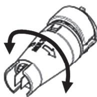
Подсоедините шланг подачи воды. Следуйте указаниям компании-поставщика воды. Стандарты разъемов указаны в спецификациях на табличке. Используйте усиленный шланг (не поставляется с данным устройством) со стандартными соединениями (внешний диаметр 16 мм, внутренний диаметр 12 мм, макс. длина 25 м)
