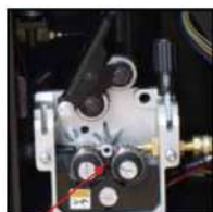
Встановіть роликів з відповідним розміром та типом канавки, який відповідає діаметру отвору контактної наконечника пальника, діаметру та виду електродного дроту.
