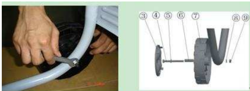
3-кришка колеса, 4-болт, 5-прокладка, 6-втулка, 7-колесо, 8-шайба, 9-гайка
