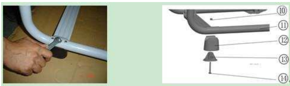
10-гайка, 11-опорна рама, 12-підставка, 13-ніжка підставки, 14-болт
