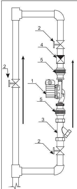
Монтаж циркуляційного електронасоса на трубопроводі:
