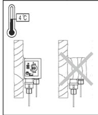
4. При стаціонарному монтажу в разі падіння температури навколишнього середовища нижче +4°C, або у випадку тривалого простою насоса, гідросистема може бути пошкоджена - може статися розрив системи водовідведення мерзлою водою або рідиною, що перекачується. Щоб уникнути розморожування системи, необхідно утеплити трубопровід і ту частину магістралі водопостачання, на яку може впливати низька температура.
