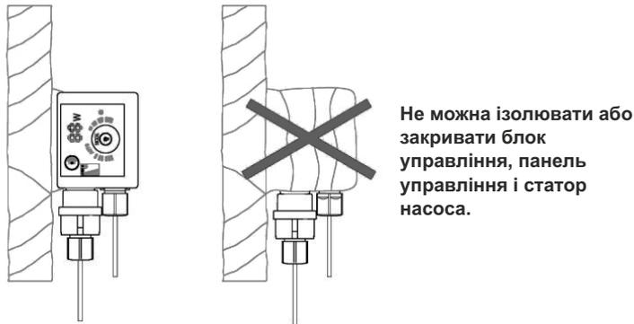
Теплоізоляція корпусу і трубопроводів насоса призначена для зменшення втрати тепла в насосі і трубопроводах і захисту їх від обмерзання.
