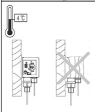
4. При стационарной установке в случае падения температуры окружающей среды ниже +4°C, или в случае длительного простоя насоса, гидросистема может быть повреждена - может произойти разрыв системы водоотведения замерзшей водой или перекачиваемой жидкостью. Чтобы избежать размораживания системы, необходимо утеплить трубопровод и ту часть магистрали водоснабжения, на которую может воздействовать низкая температура.
