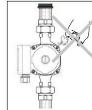
5. Поверхность насоса может быть горячей, а перекачиваемая жидкость может быть под высоким давлением, поэтому прежде чем демонтировать насос, отключите насос от цепи электропитания, перекройте элементы запорной арматуры на трубопроводе и выждете необходимое время, чтобы избежать возможных травм!
