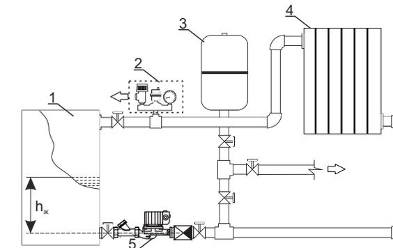
**Рекомендованная схема системы отопления:**
