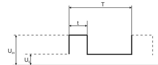
Вихідний сигнал PWM (PWM OUT) - це зворотній сигнал насоса. Частота PWM фіксується на 75Hz.
