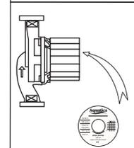
7. Параметры сети питания должны соответствовать значениям параметров, указанным в табличке на корпусе электронасоса. При длительном хранении поместите насос в сухое, вентилируемое и прохладное место при комнатной температуре, не забыв предварительно опорожнить насос.
