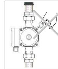
5. Поверхня насоса може бути гарячою, а перекачувана рідина може бути під високим тиском, тому перш ніж демонтувати насос, від'єднайте насос від ланцюга електроживлення, перекрийте елементи запірної арматури на трубопроводі і зачекайте деякий час, щоб уникнути можливих травм!
