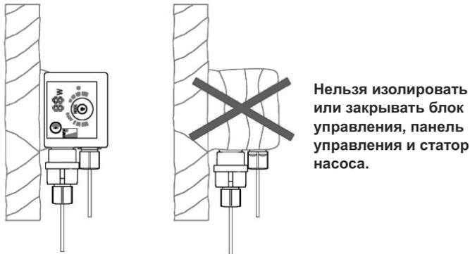
Нельзя изолировать или закрывать блок управления, панель управления и статор насоса.
