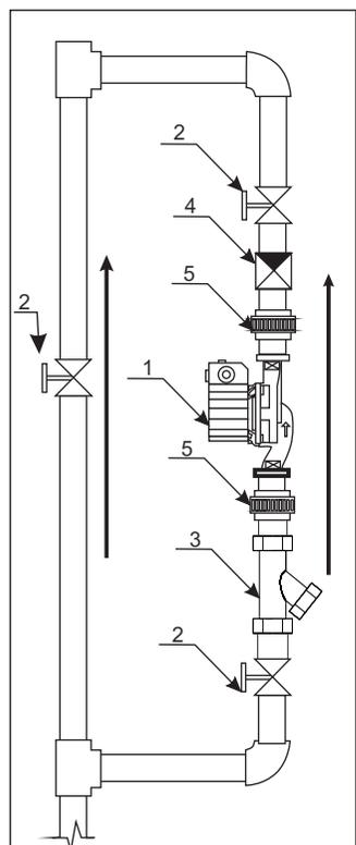
**Монтаж циркуляционного электронасоса на трубопроводе:**
