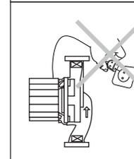
6. Следите, чтобы насос неожиданно не включился при монтаже или демонтаже, в этом случае и при длительном простое электронасоса всегда держите сетевой тумблер выключенным, а элементы запорной арматуры на напорном трубопроводе - закрытыми.
