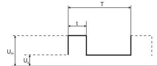
Выходной сигнал PWM (PWM OUT) – это обратный сигнал насоса. Частота PWM фиксируется на 75Hz.
