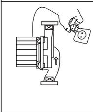
2. Электрический насос должен иметь надежное заземление для предотвращения поражения электрическим током. Для безопасности насос и цепь электропитания рекомендуем оснастить устройством защитного отключения (УЗО). Не мочить штепсель сетевого шнура.
