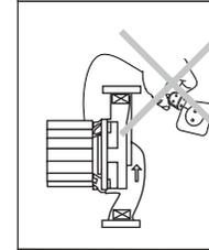
6. Слідкуйте, щоб насос несподівано не увімкнувся при монтажі або демонтажі, для цього випадку і при тривалому простої електронасоса завжди тримайте мережевий тумблер вимкненим, а елементи запірної арматури на напірному трубопроводі - закритими.
