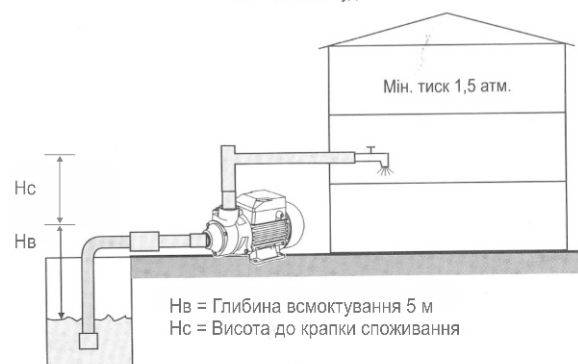
Мал. 1. Типові схеми водопостачання з використанням відцентрового моноблокового насоса.
