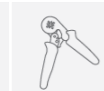
Обтискний інструмент (для трубчастих клем)
