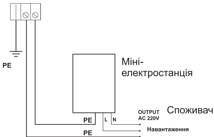
Рисунок 7. Схема заземлення виробу.
