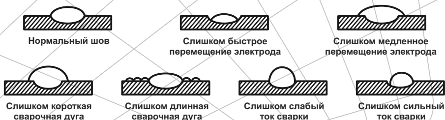
Рисунок 6. Основные виды ошибок при сварке полуавтоматом.
