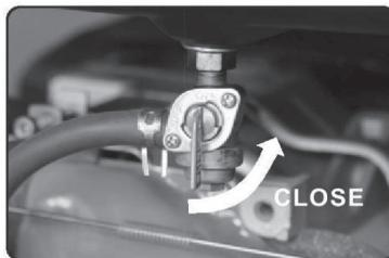
(г) Закройте топливный кранник - положение OFF (закрыто).
