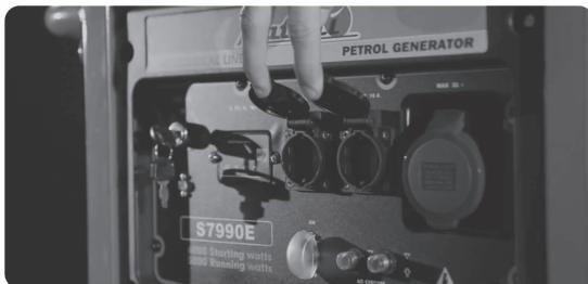
*Откройте водонепроницаемую крышку и вставьте вилку в розетку генератора*
