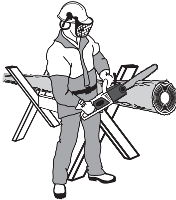
Рисунок 11. Схема розпилювання колоди із використанням козел
