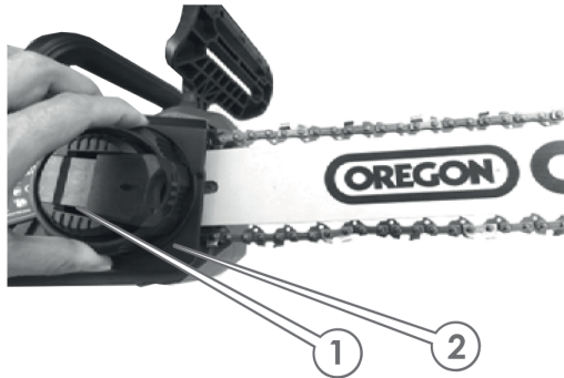
Рисунок 6. Схема регулювання натяжіння.
