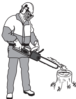
Рисунок. 9. Перевірка працездатності системи змащення напрямної та ланцюга
