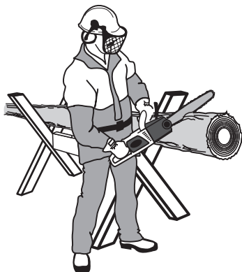
Рисунок 12. Схема розпилювання колоди із використанням козел.
