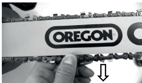
Рис. 7. Схема перевірки натягу ланцюга.
