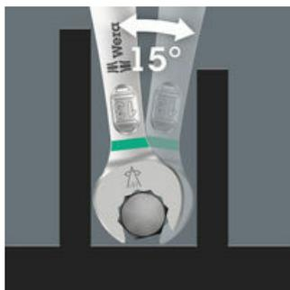
Двусторонний рожковый ключ Joker 6005, с особой формой рожковой части - с наклоном на  $7,5^\circ$  и профилем в виде двойного шестигранника - увеличивает вдвое возможности для накидывания при повторяемых поворотах ключа в процессе завинчивания на  $180^\circ$  относительно продольной оси. Гайку или головку винта можно захватывать через каждые  $15^\circ$ . Можно сказать, Joker 6005 сам находит соответствующее положение после каждого перекидывания.
