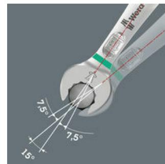
Благодаря наклону на  $7,5^\circ$  рожковой части, профилю в виде двойного шестигранника и оптимальному способу работы (накинуть - закрутить - перевернуть - снова накинуть - закрутить - перевернуть и т.д.) закручивать можно в тех случаях, когда для поворота ключом имеется угол меньше  $30^\circ$ .
