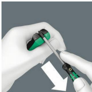
Для размагничивания инструмента его нужно провести вдоль "минуса".
