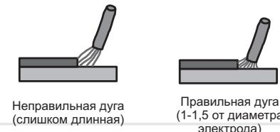
7. Для остановки процесса сварки отведите электрод от свариваемой поверхности. Правильное направление отвода электрода изображено на рисунке 3.
