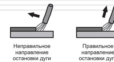
Для получения прочного сварочного соединения кроме правильного выбора сварочного тока необходимо обеспечить правильное положение электрода относительно свариваемой поверхности. Угол наклона электрода должен составлять 60-80 градусов (см. рисунок 4). При слишком большом угле наклона сварочный шов может стать пористым, при слишком малом угле – образуется большое количество брызг расплавленного металла, и дуга становится неустойчивой.
