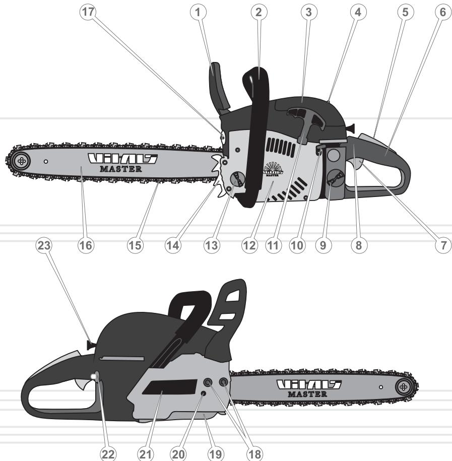
1. Рычаг аварийного тормоза цепи с защитным экраном.
