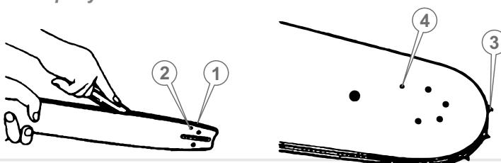
1. Удалите опилки и грязь из желоба шины, масляных отверстий и ведомой звездочки (см. рисунок 22).
