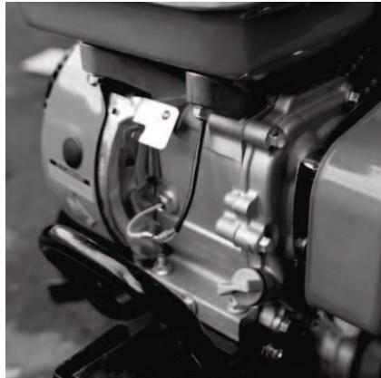
Двигатель необходимо очищать от грязи каждый раз после окончания работы с мотоблоком.
