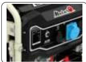
в) Вимкніть запалення, перевівши ключ вимикача у положення OFF (вимкнено).
