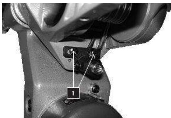
Для калібрації лазерного променя використовуйте кронштейн (приблизно 200мм x 300мм). Встановіть правильний кут променя відносно робочої поверхні.
