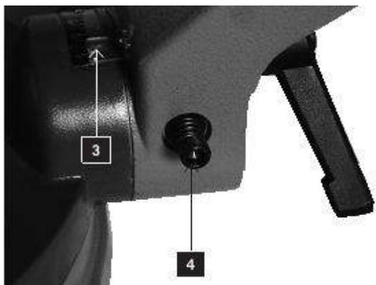
Встановіть кутомір під кутом 45° відносно столу. Якщо калібрування необхідне, то послабте гвинт (4) торцювальним ключем до 45° (3).
