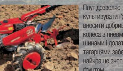
Плуг дозволяє культивувати ґрунт і вносити добрива. Великі колеса з пневматичними шинами і додатковими тягарцями забезпечують найкраще зчеплення з ґрунтом.
