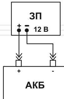
Малюнок 3: схема приєднання силових кабелів зарядного пристрою до акумулятора, який має робочу напругу 12 В (6 В).
