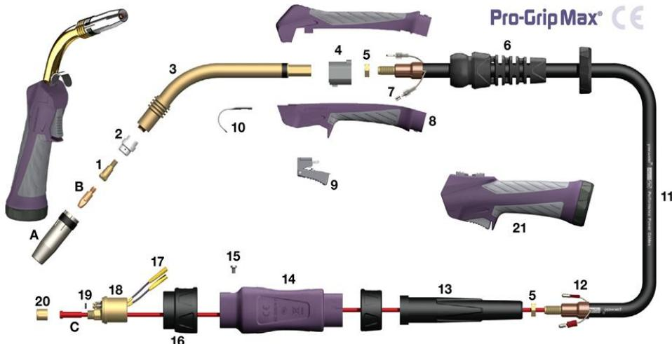
Зварювальний MIG/MAG пальник складається з трьох основних вузлів: центральний роз'єм KZ-2 для підключення до зварювального апарату; шланговий пакет, котрий містить у собі дроти керування, силовий кабель, направляючу спіраль електродного дроту та шланг для підведення газового захисту; робоча частина
