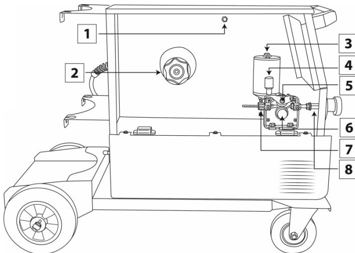
**1** Регулятор вильоту дроту після зварювання
