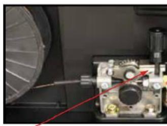
Зафіксуйте електродний дріт в механізмі подачі. Встановіть вилот дроту з випускного отвору роз'єму KZ-2, який рівний 150-200мм
