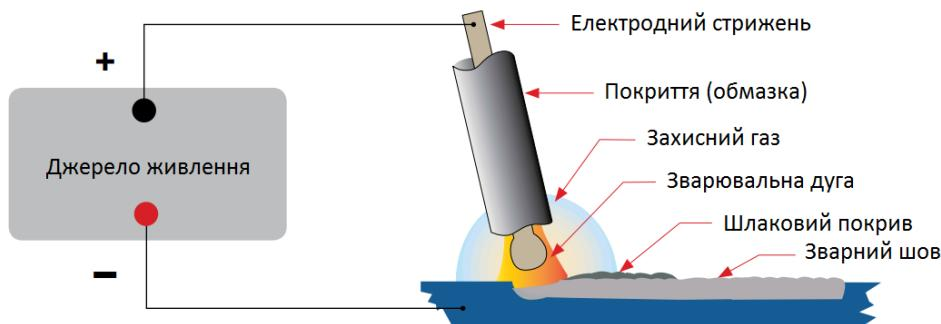
Після зварювання та остигання, шлак, що утворився від плавлення обмазки, має бути видалений механічним шляхом зі зварного шва.
