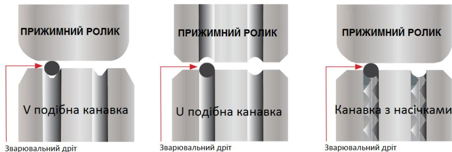
Ще один параметр підбору ролика – це кількість канавок, яких може бути одна або дві. Ролик з однією канавкою використовується для роботи одним діаметром дроту або ж може бути універсальним для двох суміжних діаметрів, маркування на такі ролики, як правило, наноситься на бічну сторону ролика.
