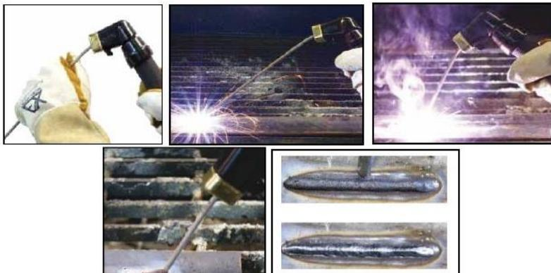
Обладнання має вбудовану функція «Форсаж дуги», яка дозволяє автоматично збільшувати струм дуги до заданої межі при зменшенні дугового проміжку. За рахунок цього стабілізується горіння дуги і перенесення електродного металу, що дозволяє поліпшити якість шва при зварюванні короткою дуговою або роботі в важкодоступних місцях. Особливо ефективним є застосування цієї функції при зварюванні у вертикальному і стельовому положеннях.
