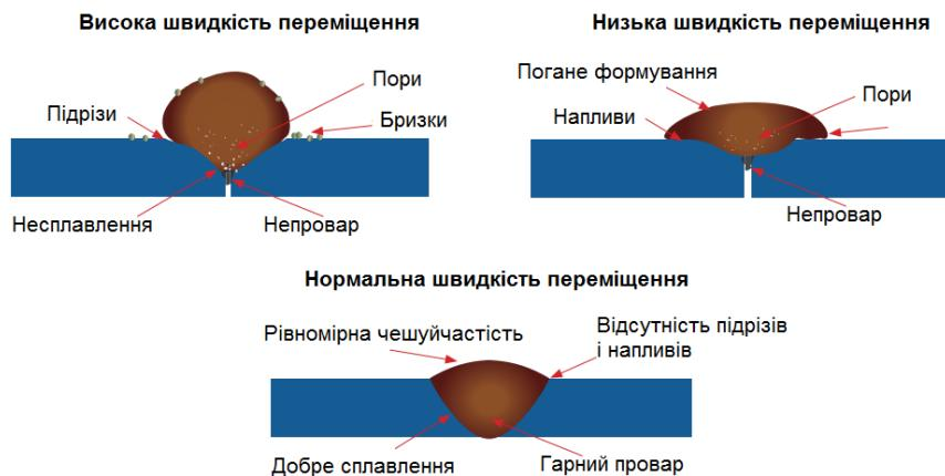
Швидкість переміщення може змінюватися в залежності від умов зварювання та кваліфікації зварника, вона обмежується здатністю зварника контролювати зварювальну ванну. Швидкість переміщення повинна відповісти величині струму зварювання, товщині та виду заготовки, технологічним вимогам до зварного шва.
