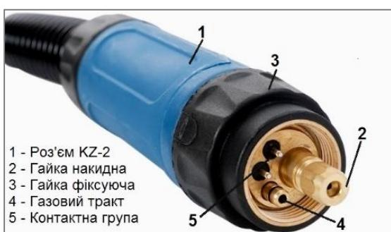
4. Підключіть шланговий пакет до зварювального апарату, попередньо протягнувши тефлоновий канал в отвір подачі електродного дроту;
