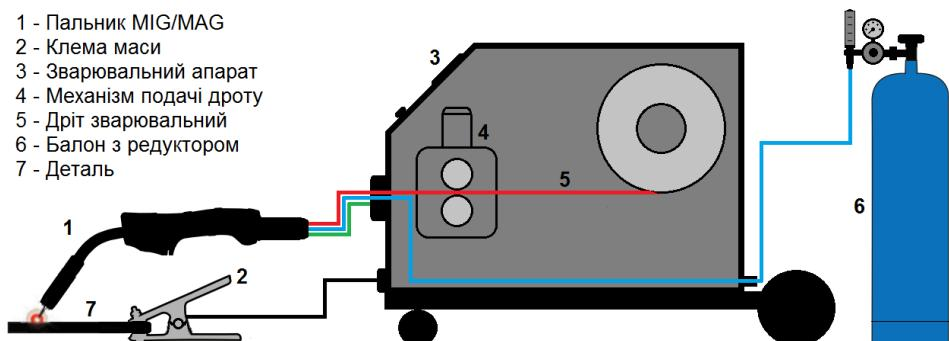
4. Переконайтесь в тому, що всі змінні частини пальника (наконечник, направляючий канал для подачі дроту), а також тип і розмір канавки ролика в механізмі подачі, відповідають діаметру та матеріалу зварювального дроту.
