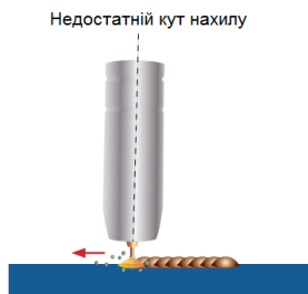
Збільшене розбризування металу, погіршений контроль зварювання
