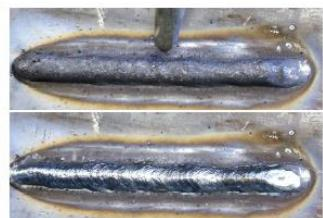
Плавно і рівномірно переміщуйте електрод уздовж поверхні деталей що зварюються, для переривання дуги, різко відведіть електрод від поверхні деталей.
