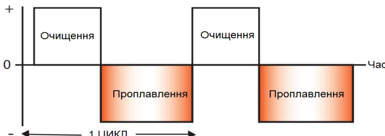
**Збільшуочи значення балансу полярності**, зварювальник збільшує тривалість півхвиль оберненої полярності: струм направлений від деталі, що зварюється до вольфрамового електроду. Це сприяє більш інтенсивному руйнуванню оксидної плівки і очищенню поверхні деталі, що зварюється. При цьому тугоплавкий вольфрамовий електрод може почати руйнуватися (оплавлятися) від перегріву.
