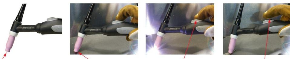
Тримайте пальник над деталлю, спершись на керамічне сопло під кутом, щоб забезпечити відстань 1-3 мм від електрода до заготовки. Натисніть на кнопку керування на пальнику і в проміжку між електродом та деталлю запалиться електрична дуга. Після цього, не торкаючись соплом заготовки, тримайте пальник зі збереженням постійного зазору між електродом і заготовкою (близько 2-3мм), для отримання стабільної зварювальної дуги.
