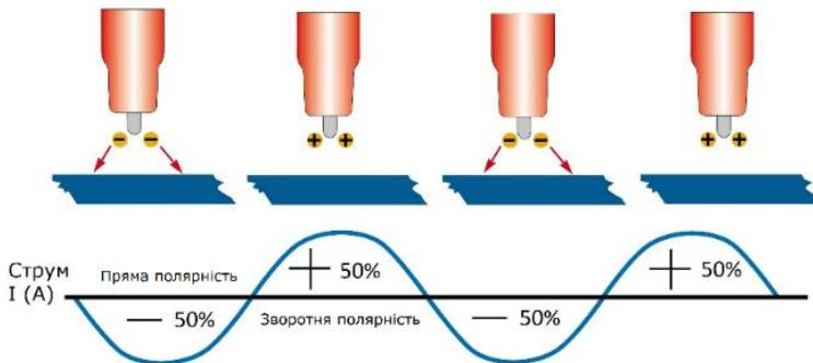
Після цього, не торкаючись соплом заготовки, тримайте пальник зі збереженням постійного зазору між електродом і заготовкою (близько 2-3мм), для отримання стабільної зварювальної дуги. Змінний струм (AC) складається з півхвиль прямої і зворотної полярності. Струм зворотної полярності руйнує оксидну плівку на поверхні зварюваного металу, в той час як струм прямої полярності плавить його. На малюнку показано вихідне (діюче) значення зварювального струму.
