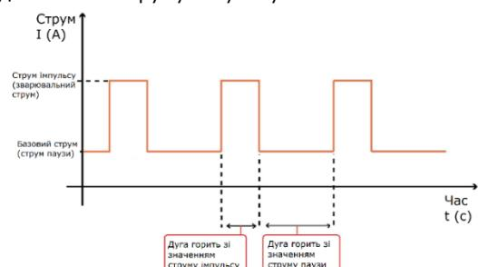
**Коефіцієнт заповнення** - процентне відношення часу горіння дуги зі значенням струму імпульсу до загальної тривалості одного циклу перемикань.
