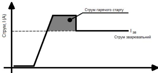
**Функція «Anti Stick»** - апарат автоматично знижує зварювальний струм до нуля при «залипанні» електроду, це дозволяє швидко відірвати електрод від металу і далі продовжувати роботу, відновлення заданого струму зварювання відбувається одразу після відриву електроду, що залип.
