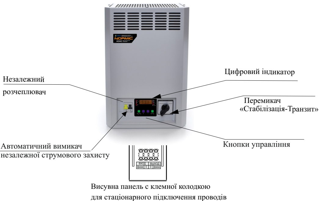
Малюнок 3. Загальний вигляд нормалізаторов серії NORMIC.
