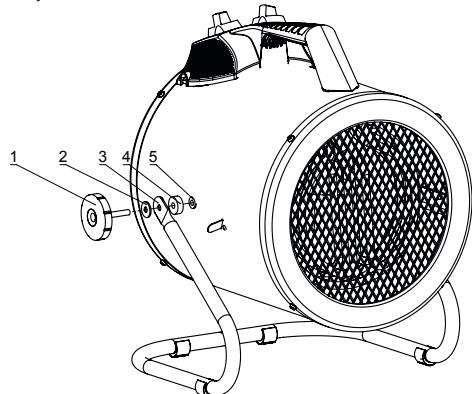
Рис. 3 – Установка тепловентилятора на опору
