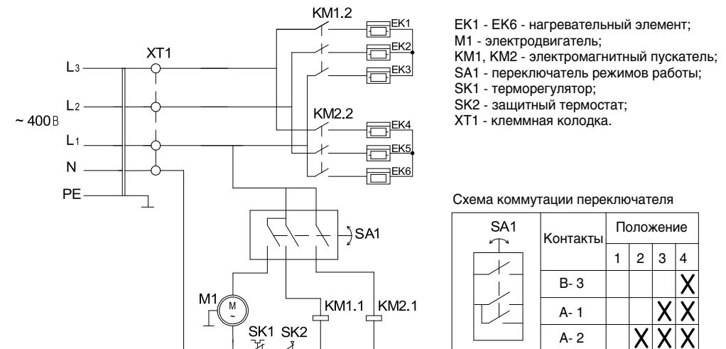
Рис. 4. Схема электрическая тепловентиляторов BHP-ME-15
