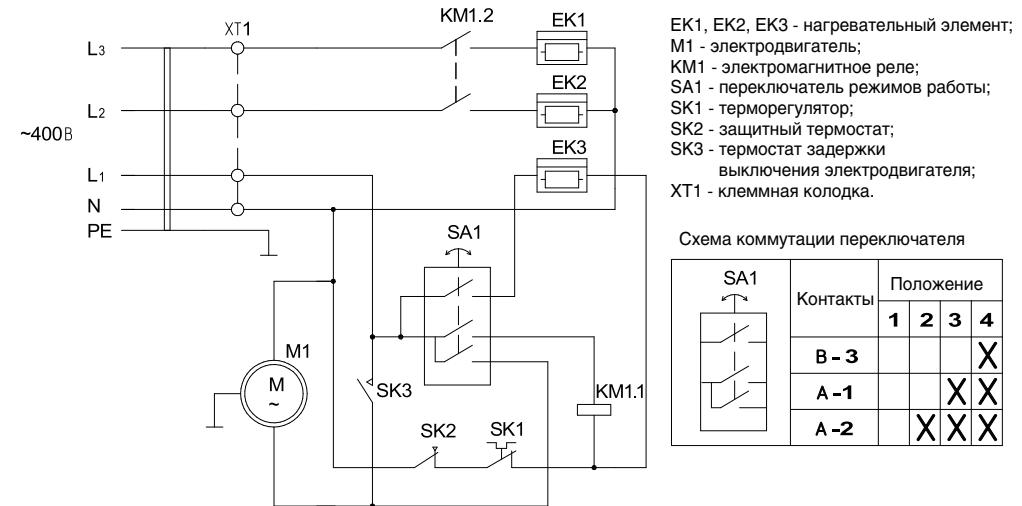
Рис. 3. Схема электрическая тепловентиляторов BHP-ME-9
