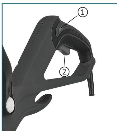
Вставьте вилку триммера в розетку удлинителя(не входит в комплектацию) и закрепите его на ручке. При первом включении триммера проследите, чтобы нейлоновая леска касалась или выступала за нож, укрепленный на кожухе. Нажмите на кнопку-предохранитель случайного запуска (1) и кнопку ВКЛ./ВыКЛ. (2) и дайте триммеру поработать на холостом ходу, чтобы автоматически отрегулировать длину лески. Чтобы выключить триммер, просто отпустите кнопку ВКЛ./ВыКЛ.
