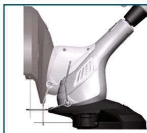
Триммер HYUNDAI GC 550 имеет возможность регулировки наклона косильной головки. Вы можете установить головку как горизонтально так и вертикально для торцевого подравнивания углов садово-вого участка. Регулировка производится с помощью кнопки на нижней части триммера (1). Нажав ее, вращайте головку в необходимую вам сторону, отпустив кнопку вы зафиксируете положение головки.
