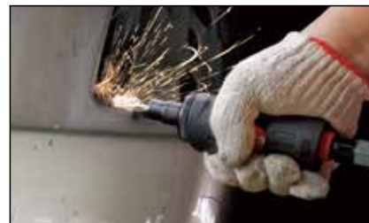
▲ Operation of Mini Die Grinder
