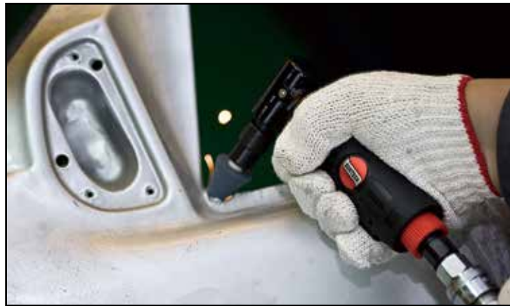
▲ Operation of Mini Die Grinder
