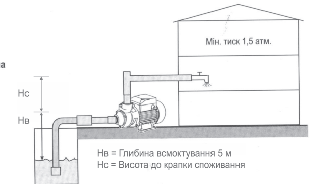
Мал. 1. Типові схеми водопостачання з використанням відцентрового поверхневого насосу.
