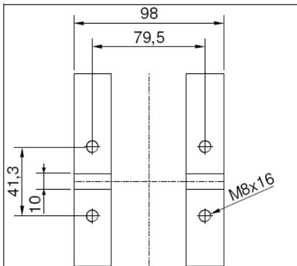
С помощью 4-х болтов M8 закрепите опорную подставку дрели PLD 450 на штатив стойки.
