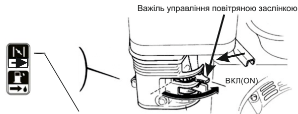
Символ, що означає "Відкрити повітря заслінку" (стрілкою вказаний напрям переміщення важеля)
