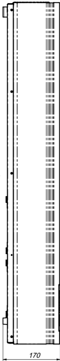
Рисунок 8. Габаритні розміри стабілізаторів Герц на 100-125А
