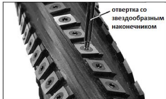
Рис. 30 (для строгального вала Helical)
