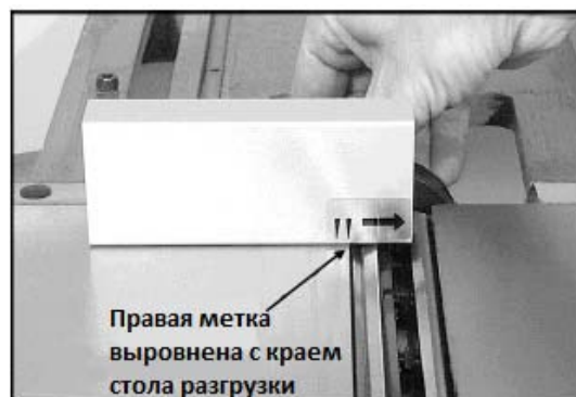
Рис. 22 (строгальный вал с прямым расположением ножей)
